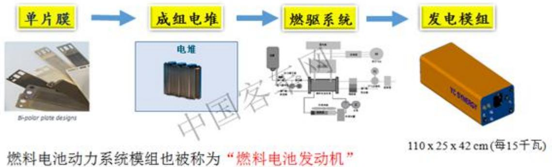
电堆和燃驱系统是燃料电池的两大核心技术
